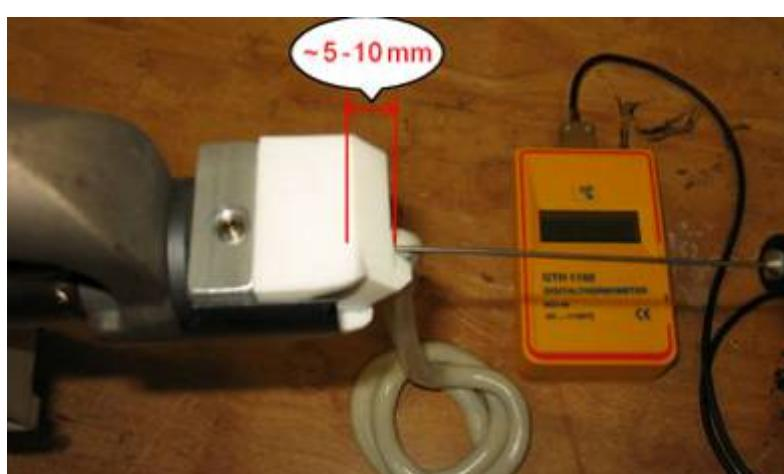
Изменение калибровки датчика температуры материала в рабочем режиме автоматически изменяет запрограммированное «Корректирующее значение калибровки датчика температуры материала **TMat Δ**» (см. подробнее в п.4.2.2).
